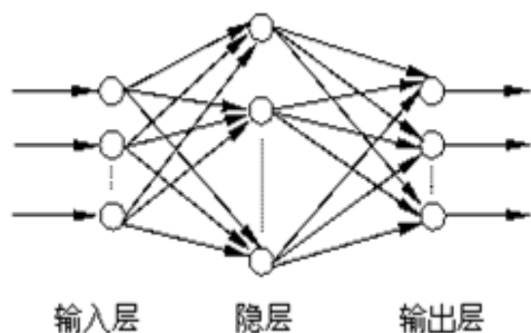
图 2-BP 神经网络模型拓扑结构图
