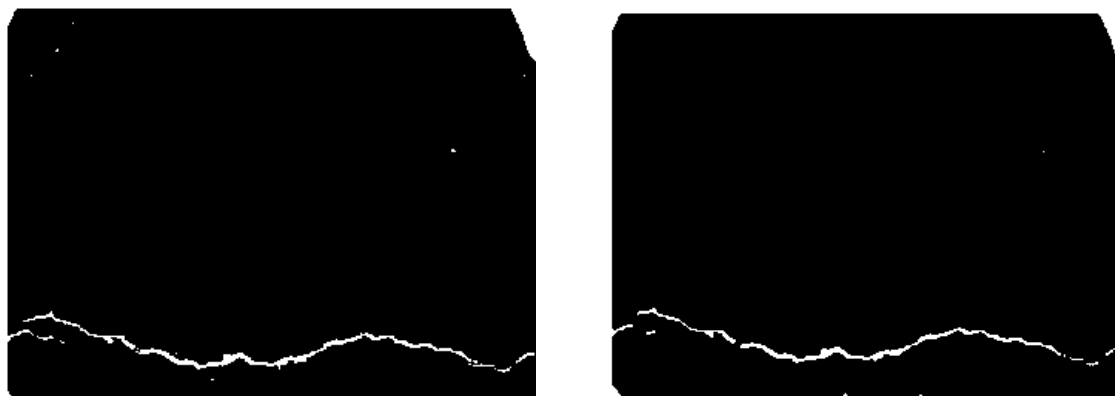
图 2-6 小波包和中值滤波相结合的方法对道路图片滤波后的图像
